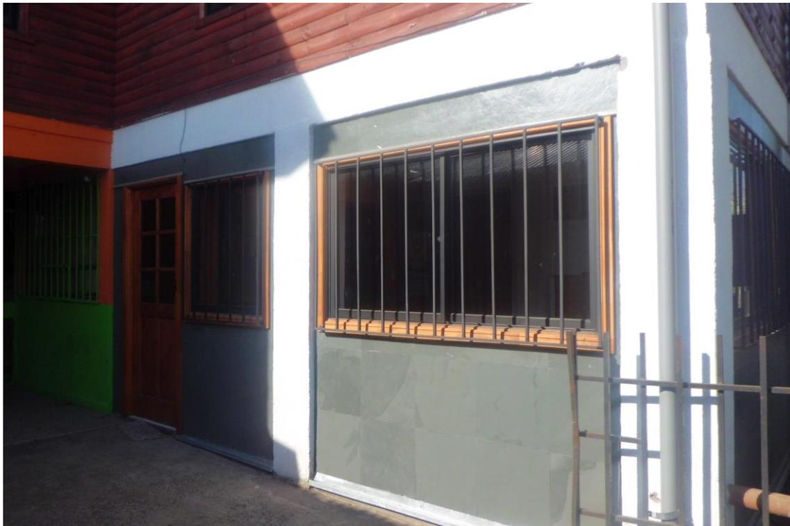
Construcción 32 m<sup>2</sup> sobre radier, estructura de albañilería y tabiquería de madera, revestimiento de cielo. Una oficina y una bodega.
