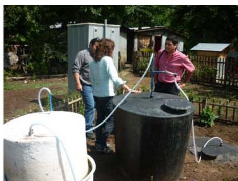
Biodigestor primer prototipo modelo indio
