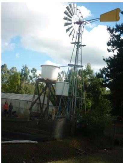
Molino de Viento para extracción de agua para riego
